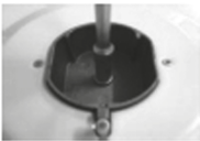
4. Enjektörü saat yönünün tersine çevirerek sökünüz.
