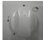
6. Düğmeyi yerinden dikkat ederek çıkartınız Valf milinin içindeki deliğe (Gaz emniyetli için valf milinin sağ altındaki deliğe) uygun düz tornavidayı saat yönünün tersine çevirerek maksimum alev, saat yönünde çevirerek minimum alev ayarını yapabilirsiniz.
