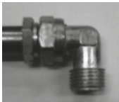
7. LPG gaz giriş rekorunu sökünüz. NG (Doğal Gaz) bağlantısı için flex boruyu yerine takınız.
